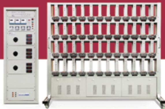
Установка технологического прогона HEBA-Тест с источником фиктивной мощности.
